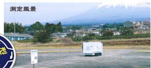
※エンジンユニット単体での騒音測定 (社)日本建設機械化協会 測定距離16m
