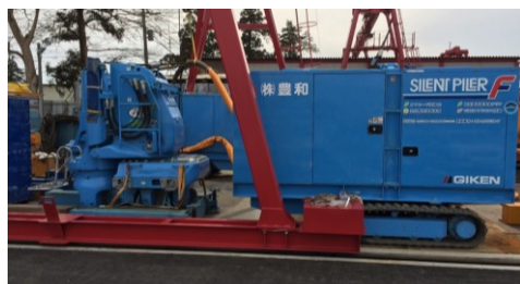
5.サイレントパイラー
