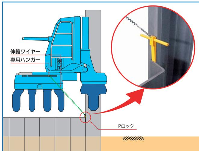
鋼矢板継手部に挿入して使用する自走用の補助具で、クサビ効果により鋼矢板同士をロックします。
